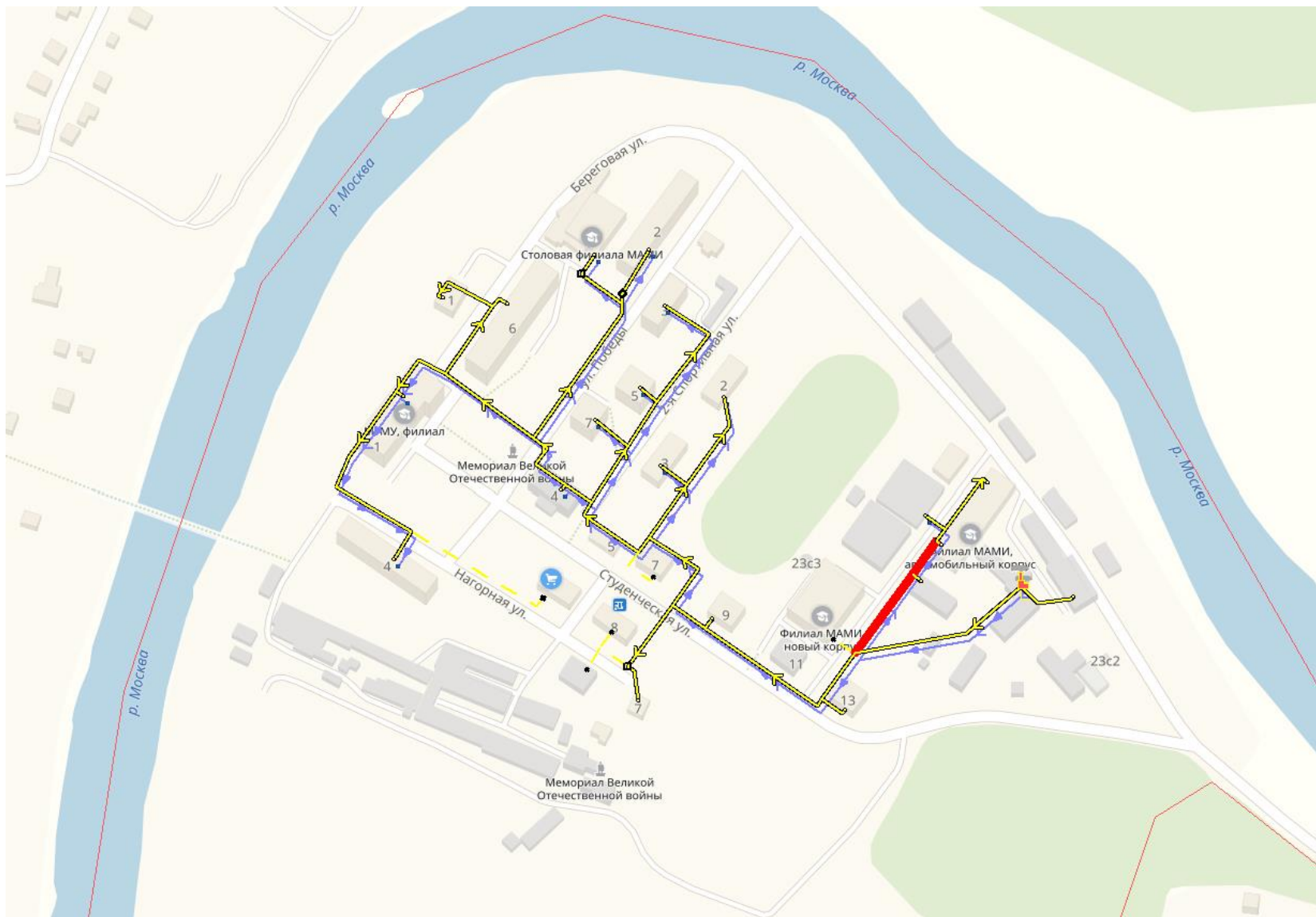
Рисунок 6.4.7 - Участки тепловой сети, подлежащие перекладке по результатам гидравлического расчета, котельной п. Тучково, Автотранспортный колледж.
