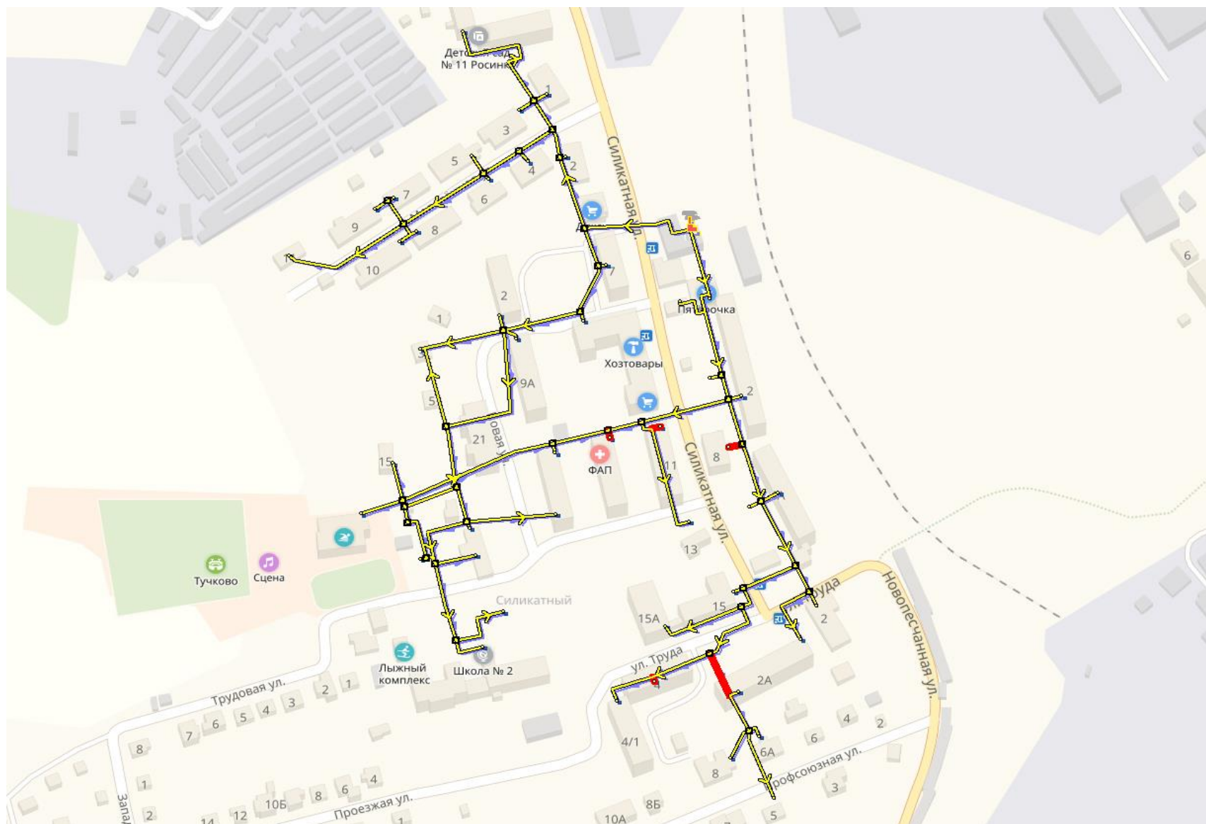
Рисунок 6.4.6 - Участки тепловой сети, подлежащие перекладке по результатам гидравлического расчета, котельной п. Тучково, ул. Силикатная.
