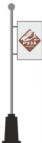
Отдельно стоящие на земле, крепящиеся на стене здания или опоре освещения объекты информации, имеющие внешние поверхности для размещения информации и состоящие из фундамента, каркаса и информационного поля.
