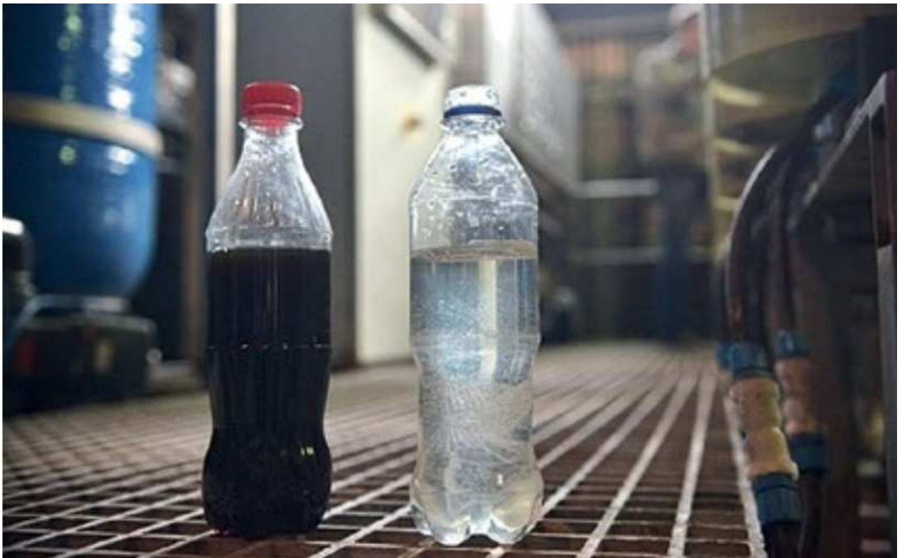
Рис. 37 Слева фильтрат с полигона ТКО, справа результат очистки с применением технологии обратного осмоса.
