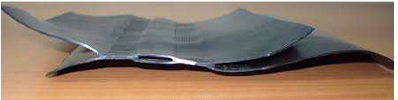
Рис.33 Образец сварного шва геомембран.
