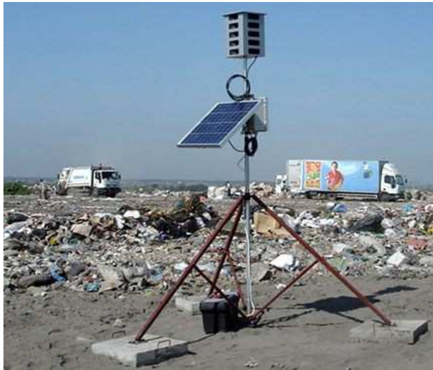
Рис.4 Отпугиватель в рабочем положении укомплектованный аккумулятором и солнечной батареей для подзарядки
