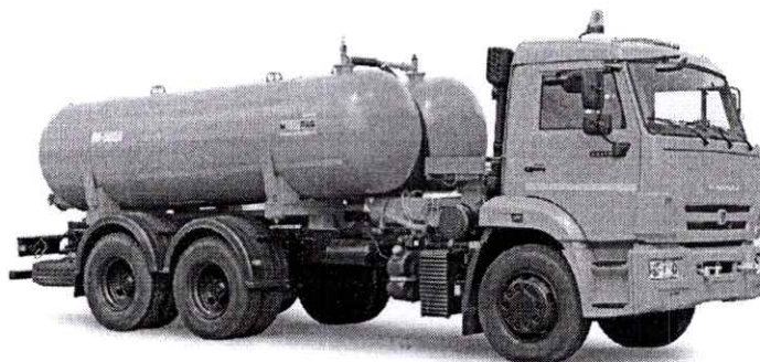
Рис. 5.1. Вакуумная машина КО-505А на шасси КамАЗ-65115-71
