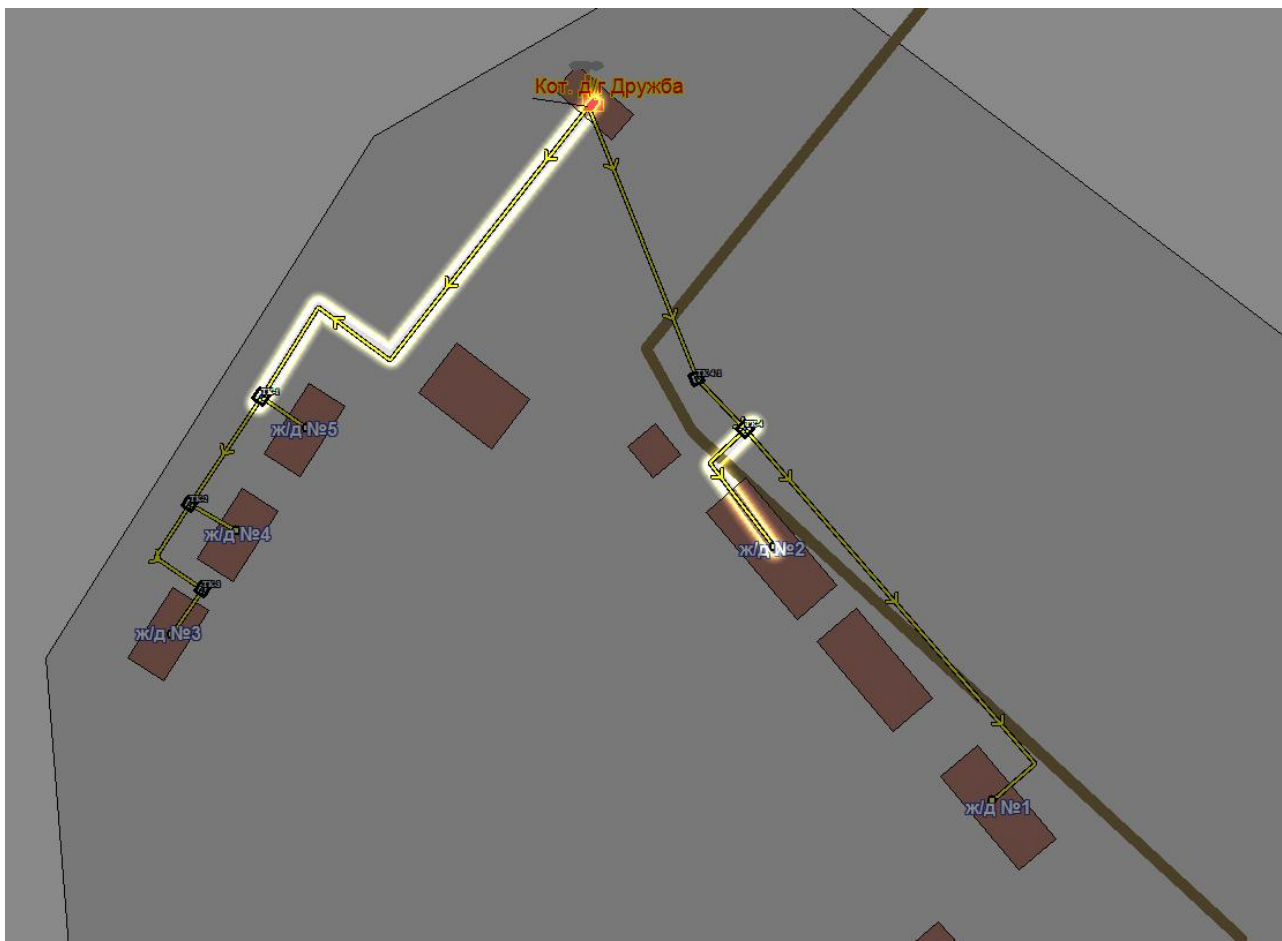
Рисунок 7.3 - Участки тепловой сети котельной п. Колюбакино, детский санаторий "Дружба" с завышенными удельными сопротивлениями
