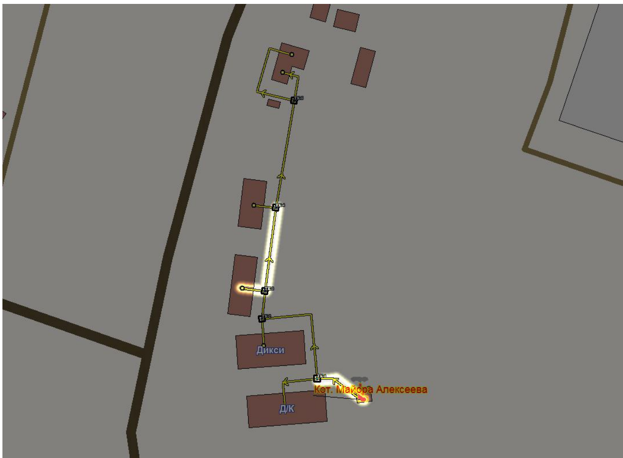
Рисунок 7.4 - Участки тепловой сети котельной п. Колубакино, ул. Майора Алексеева "клуб" с завышенными удельными сопротивлениями
