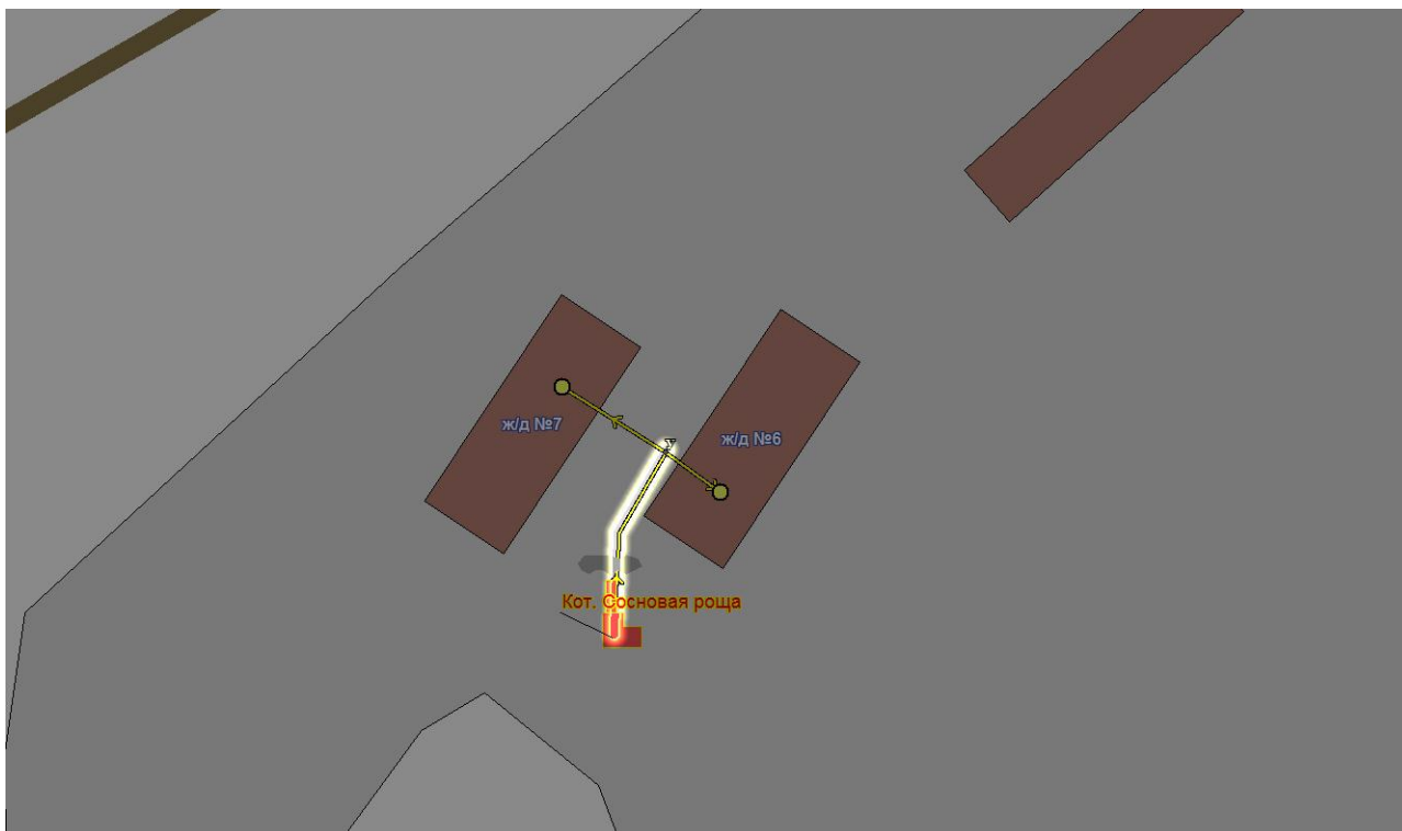
Рисунок 7.2 - Участки тепловой сети котельной п. Колубакино, ул. Заводская, д.80 («Сосновая роща») с завышенными удельными сопротивлениями
