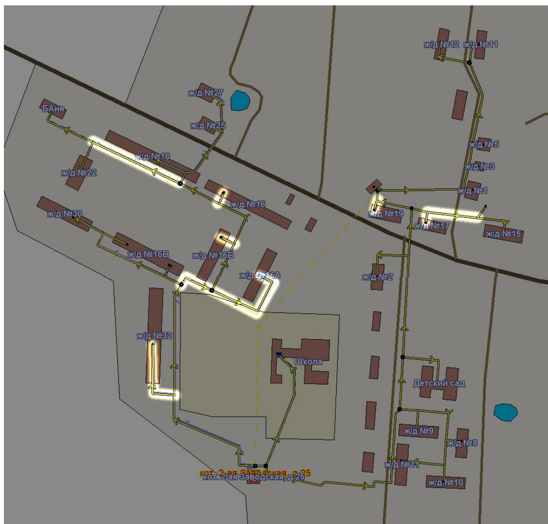
Рисунок 7.1 - Участки тепловой сети котельной п. Коллюбакино, ул. 2-ая Заводская, д.25 с завышенными удельными сопротивлениями
