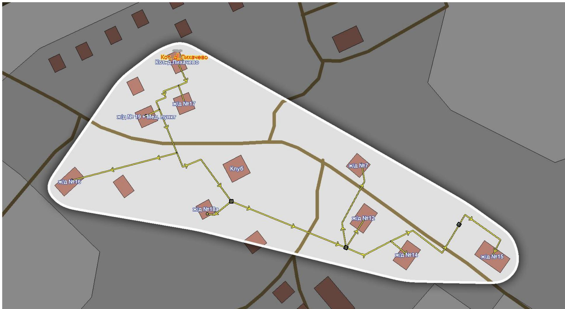
Рисунок 2.6 - Зона действия системы теплоснабжения котельной д. Лихачево сельского поселения Ивановское
