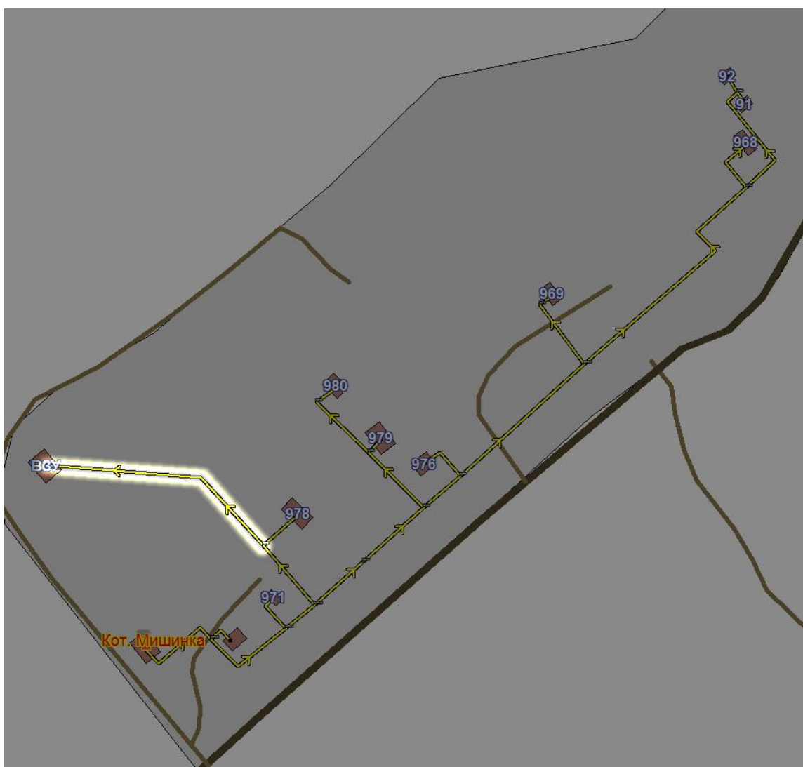
Рисунок 7.3 - Участки тепловой сети котельной п. Дорохово, 1-я Рабочая, д. 3 с завышенными удельными сопротивлениями
