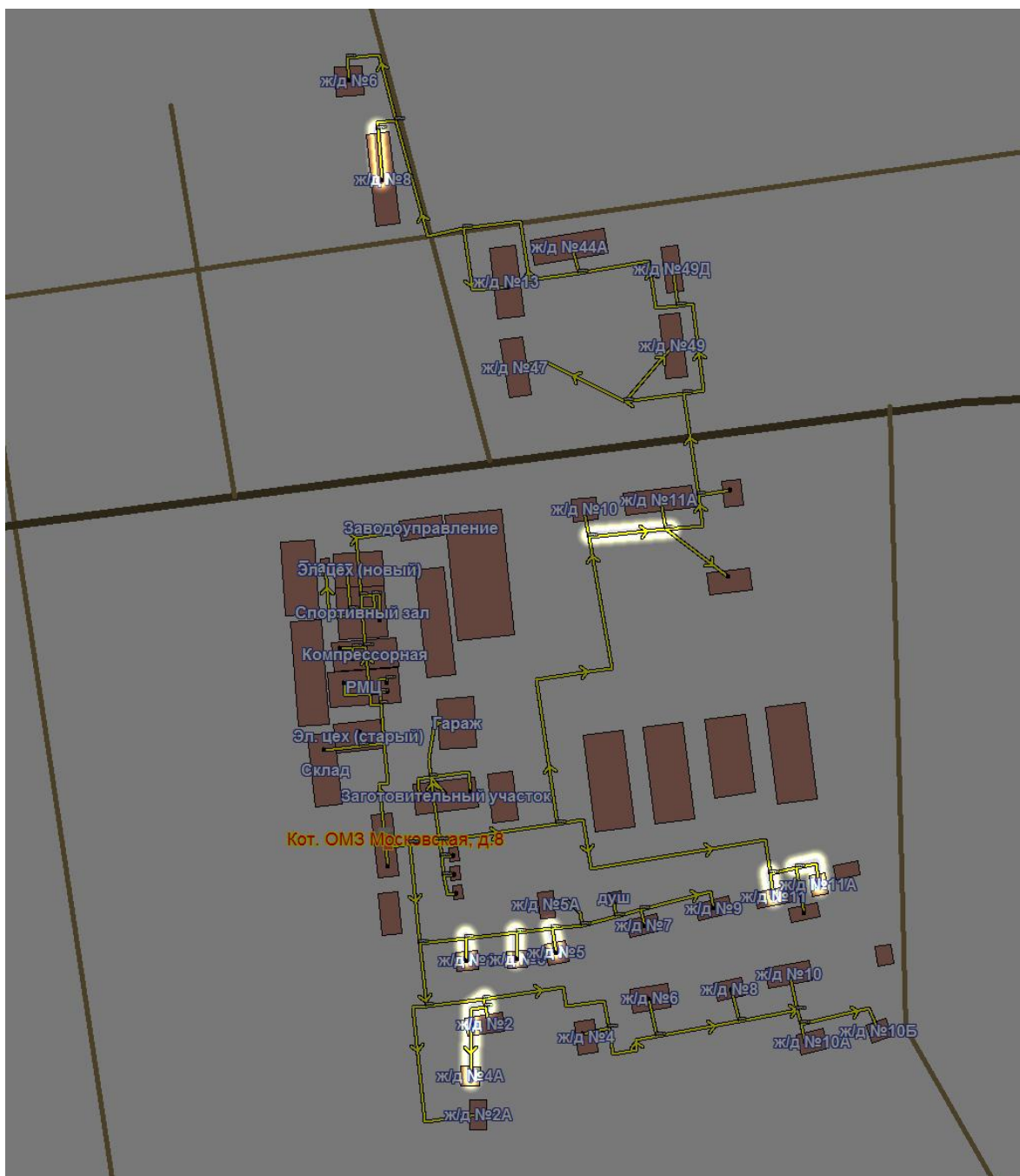
Рисунок 7.2 - Участки тепловой сети котельной п. Дорохово, ул. Московская, д.8, стр.1 с завышенными удельными сопротивлениями
